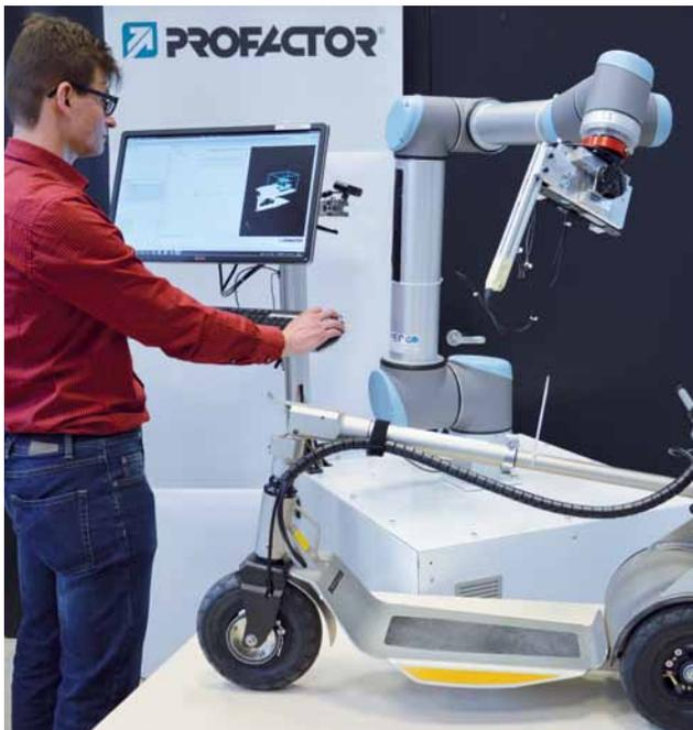
Von Robotern ist man gewohnt, dass sie ihre Aufgaben maßgeschneidert durchführen. Fallen andere Arbeitsschritte an, ist in der Regel eine aufwendige Umprogrammierung nötig. Das steht einer flexiblen Produktion entgegen. PROFACOR entwickelt Systeme, die von den ArbeiterInnen selbst konfiguriert werden können und unterschiedlichste Aufgaben wahrnehmen.
